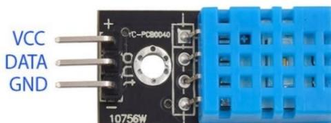
Figure 2: DHT11 Sensor
